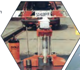
Überbohren von Wasserschiebern bis Ø 200 mm
