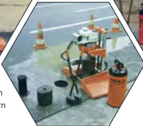
Gewicht des Bediener sorgt für festen Halt
