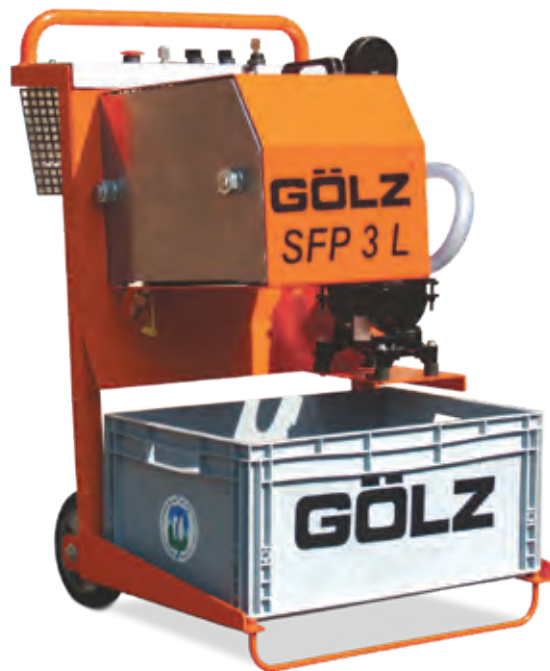
SchlammLux mit Nasssauger
